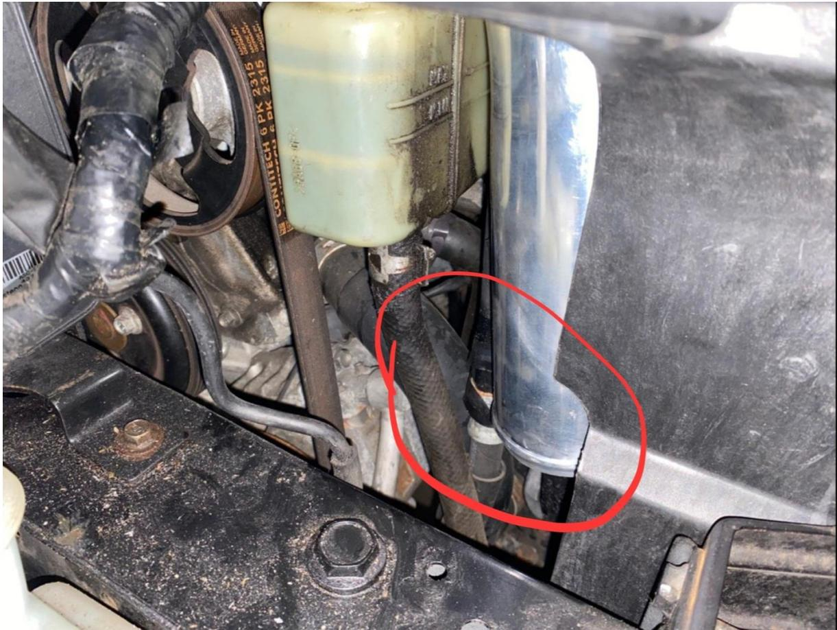
11. Auf der Kalten Seite wo die Verrohrung zur Ansaugbrücke geht muss eine Lochdurchführung durch die Plastikabschirmung des Wasserkühlers geschnitten werden. Beachten Sie auch das sie nicht die beiden Rohre vertauschen (Siehe Foto)
