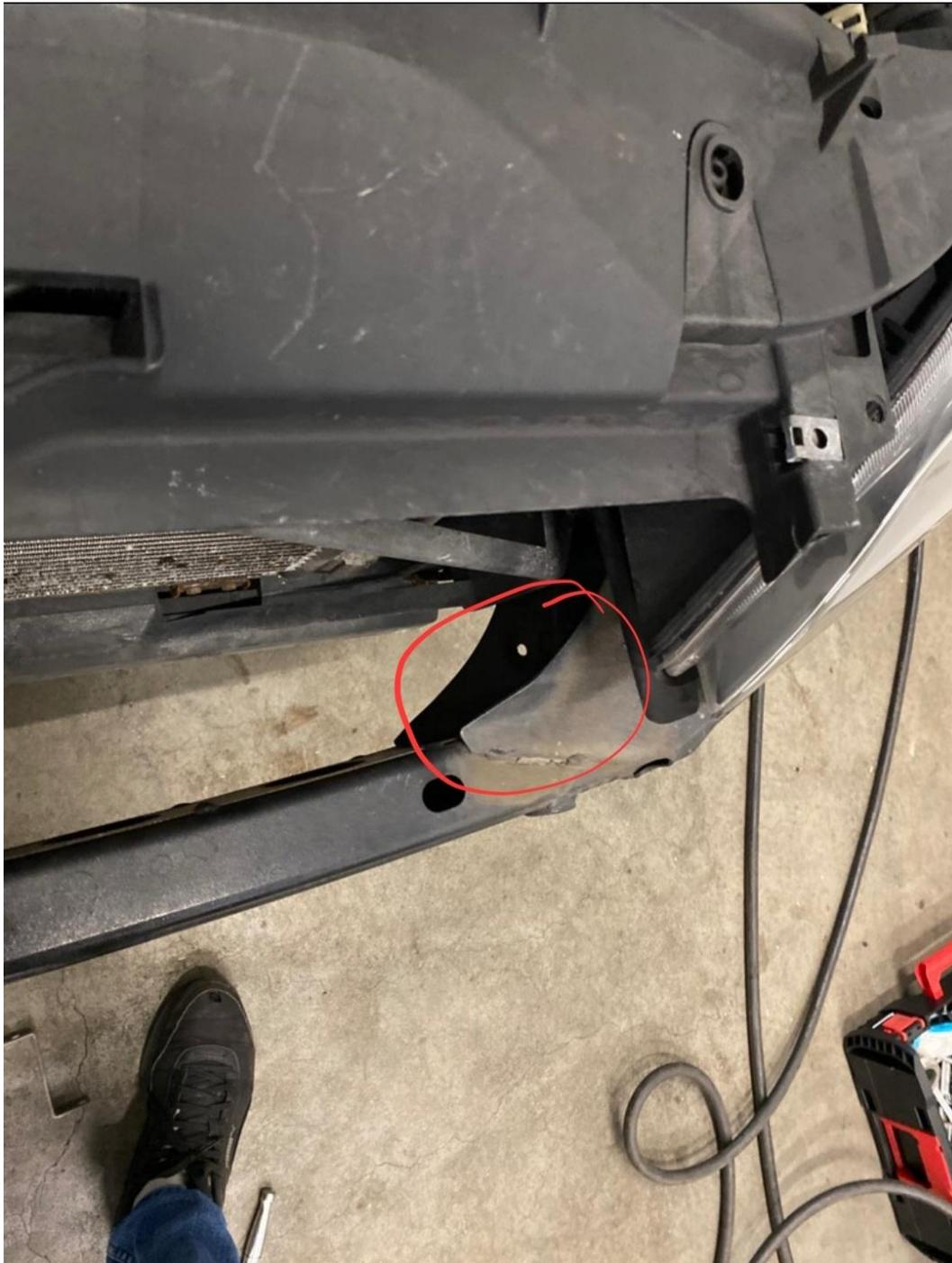
3. Entfernen Sie einen Teil des Materials an der Abgebildeter Strebe innen.
