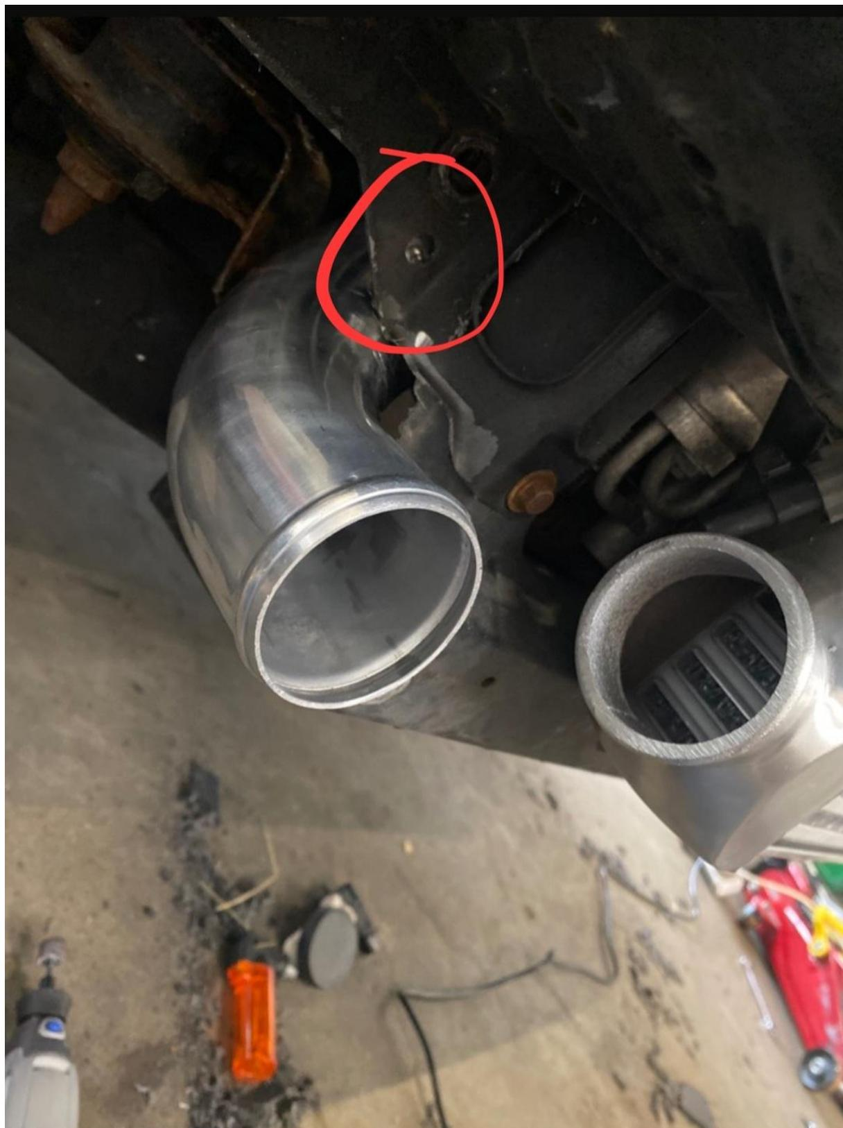
10. Hier wird die Position des Langer Rohres was zum Turbolader geht gezeigt. Um die Anbringung und Befestigung des Silikonverbinder zu erleichtern demontieren Sie den Scheinwerfer (Beifahrerseitig)
